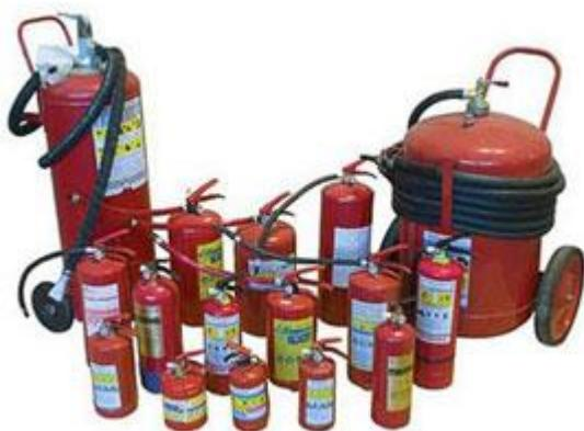
Огнетушители порошковые можно разделить на закачные (заряжены огнетушащим порошком и инертным газом под давлением 16 атм, это может быть азот, углекислота или воздух) и газогенераторные (принцип действия заключается в использовании энергии генерируемого газа для аэрирования выброса огнетушащего порошка).
